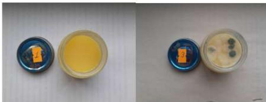
**Рисунок 2. Испытание биостойкости липосомальных композиций на основе рапсового масла и биоцида Катон (слева) и только рапсового масла (справа)**
